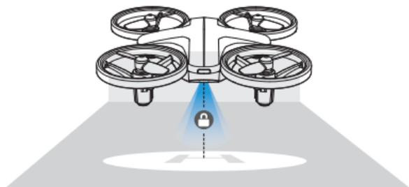
Die Drohne ist mit einer **Höhenhalte** funktion ausgestattet, um ihre Höhe nach dem Loslassen des linken Joysticks beizubehalten. (Der linke Joystick springt automatisch in die Mitte zurück)
