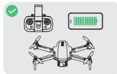
Stellen Sie sicher, dass der Transmitter, das Mobiltelefon und die Drohnenbatterie vollständig aufgeladen sind.
