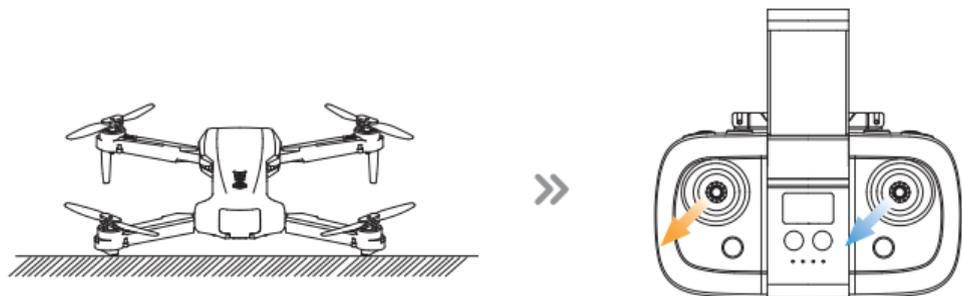
Stellen Sie sicher, dass Sie die Drohne auf eine ebene Fläche platzieren, bevor Sie das Gyroskop kalibrieren. Drücken Sie gleichzeitig den linken und den rechten Joystick in die untere linke Ecke, um das Gyroskop zu kalibrieren. Die Anzeigelampen an der Drohne werden blinken und dann konstant leuchten, was anzeigt, dass die Kalibrierung abgeschlossen ist.
