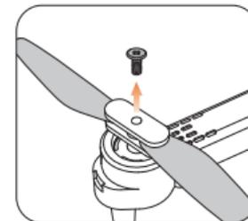
Zum Entfernen des Propellers nutzen Sie bitte den mitgelieferten Schraubendreher, um die Schrauben gegen den Uhrzeigersinn zu lösen und den Propeller abzunehmen.
