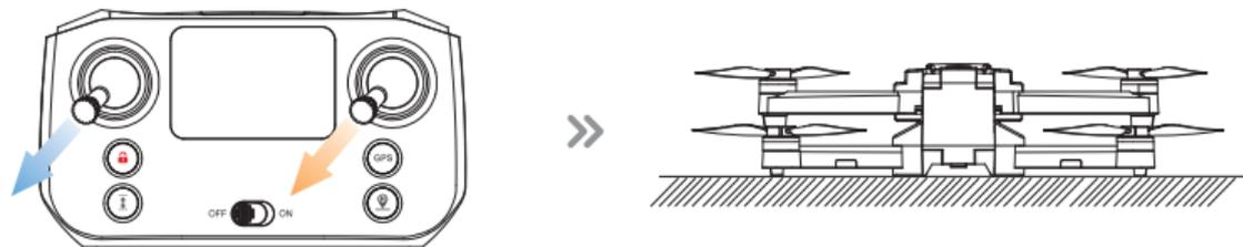
Stellen Sie sicher, dass die Drohne auf einer ebenen Fläche steht, bevor Sie den Kreisel kalibrieren. Drücken Sie den linken Joystick und den rechten Joystick gleichzeitig in die linke untere Ecke, um den Kreisel zu kalibrieren. Alle Lichter der Drohne blinken und leuchten dann dauerhaft, was bedeutet, dass die Kalibrierung abgeschlossen ist.
