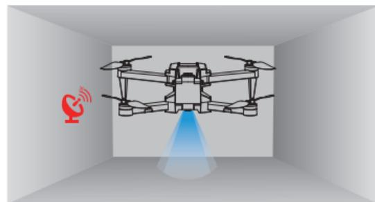
Das optische Fluss-Positionierungssystem wird typischerweise in Innenräumen verwendet, wenn das GPS-Signal schwach ist oder nicht zur Verfügung steht. Es funktioniert am besten, wenn die Flughöhe der Drohne weniger als **0.5-3**
