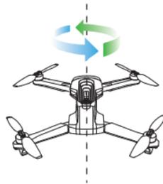
③ Halten Sie die Drohne seitlich. Drehen Sie die Drohne um 360° auf der Mittelachse, bis die hinteren Anzeiger von schnell blinkend auf dauerhaft leuchten.
