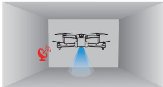
Das optische Fluss-Positionierungssystem wird typischerweise in Innenräumen verwendet, wenn das GPS-Signal schwach ist oder nicht zur Verfügung steht. Es funktioniert am besten, wenn die Flughöhe der Drohne weniger als **0.5-3 Meter** beträgt.
