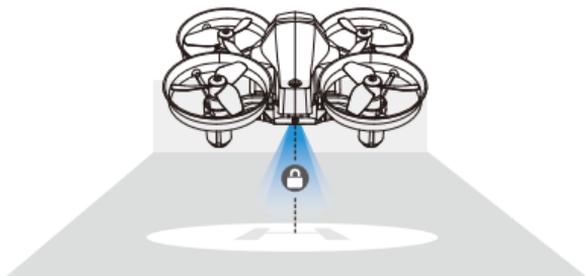
Die Drohne ist mit einer **Höhenhalte** funktion ausgestattet, um ihre Höhe nach dem Loslassen des linken Joysticks beizubehalten. (Der linke Joystick springt automatisch in die Mitte zurück)
