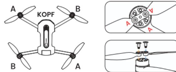
Die Drohne wird nicht abheben, wenn nicht der korrekte Propeller auf der passenden Motorachse montiert ist. Jeder Propeller ist entweder mit einem "A" oder einem "B" markiert. Sichern Sie den Propeller mit Schrauben an der Motorachse, indem Sie jede Schraube im Uhrzeigersinn festziehen.
