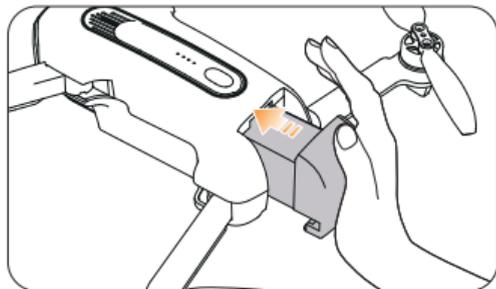
Schieben Sie die Batterie korrekt in die Drohne ein. Achten Sie darauf, dass Sie ein Klickgeräusch hören, welches anzeigt, dass die Batterie fest installiert ist.
