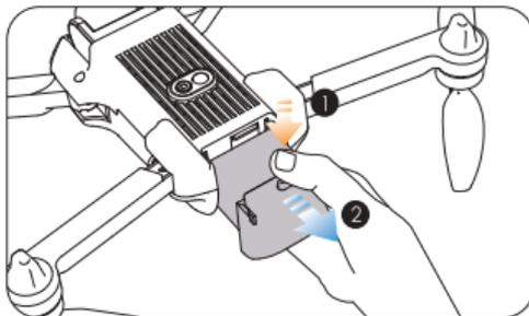
Drehen Sie die Drohne um. Drücken Sie den Verriegelungsknopf an der Batterie und ziehen Sie die Batterie aus der Drohne heraus.
