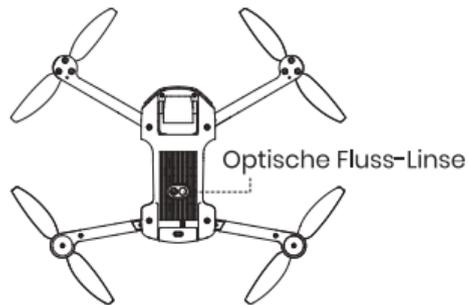
Das Optical-Flow-Positionierungssystem besteht aus einem Kameramodul, das die Positionsdaten der Drohne durch visuelle Bilder erfasst, um eine präzise Positionierung der Drohne sicherzustellen.
