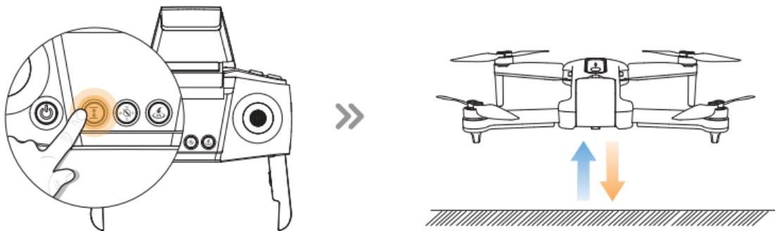
**Abheben** Kurzer Druck auf die Taste, die Drohne wird automatisch abheben und auf einer Höhe von etwa 1,2 Metern schweben. Jetzt können Sie die Drohne mit den Joysticks steuern.
