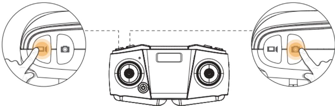
**Videoaufnahme:** Kurzer Druck auf die
