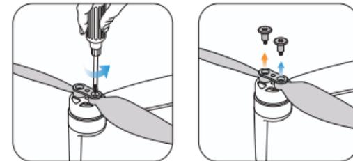
Zum Entfernen des Propellers nutzen Sie bitte den mitgelieferten Schraubendreher, um die Schrauben gegen den Uhrzeigersinn zu lösen und den Propeller abzunehmen. Halten Sie dabei den Motor fest.
