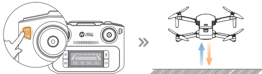
**Abheben** Kurz drücken Sie die (
