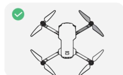
Stellen Sie sicher, dass die Propeller und die Arme vollständig ausgefaltet sind.
