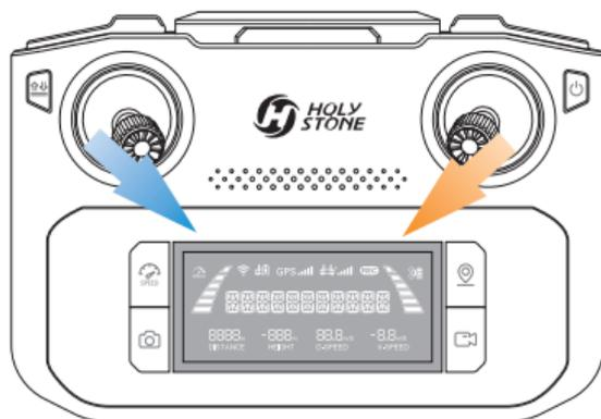
Drücken Sie, wie oben abgebildet, beide Joysticks gleichzeitig in Richtung der inneren, unteren Ecken. Die Motoren beginnen sich zu drehen, die Drohne ist entriegelt.
