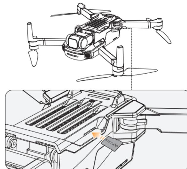
Stecken Sie eine TF-Karte (**nicht im Lieferumfang enthalten**) in den TF-Kartensteckplatz, bevor Sie die Drohne einschalten. Diese Drohne unterstützt TF-Karten mit einer maximalen Speicherkapazität von 256 GB.
