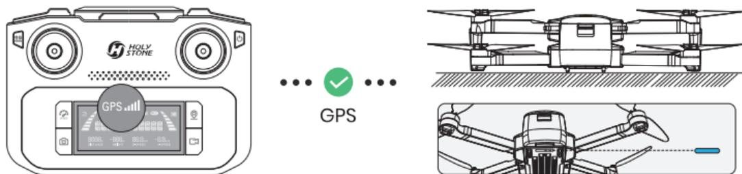
Nach der Kalibrierung des Kompasses stellen Sie die Drohne auf eine ebene Fläche. Achten Sie darauf, dass keine externen Quellen für Signalinterferenzen in der Nähe sind. Die Drohne führt automatisch eine Suche nach GPS-Signalen durch. Die Drohne hat das GPS-Signal erfolgreich gefunden, wenn die Statuslampe der Drohne dauerhaft blau leuchtet.
