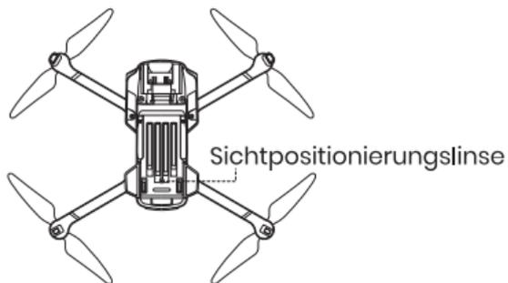
Das Optical-Flow-Positionierungssystem besteht aus einem Kameramodul, das die Positionsinformationen der Drohne durch visuelle Bilder erfasst, um eine präzise Positionierung der Drohne zu gewährleisten.
