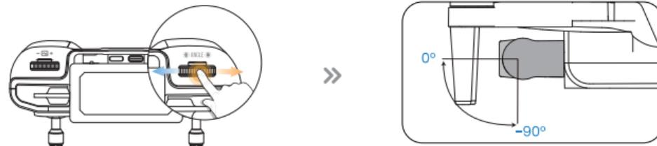
Stellen Sie den Kamerawinkel ein, indem Sie das Kamera-Einstellung-Rädchen (Ⓢ ANGLE Ⓢ) drehen ("Tilt"-Bereich: -90°~ 0°)
