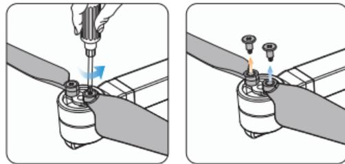
Drehen Sie die Schrauben mit dem Schraubendreher gegen den Uhrzeigersinn, um sie zu entfernen. Ziehen Sie dann die Propeller nach oben.
