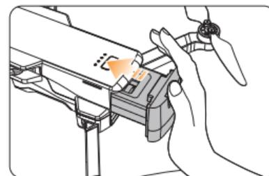
Schieben Sie die Batterie in den Rumpf. Vergewissern Sie sich, dass Sie beim Einsetzen der Batterie ein Klicken hören, das anzeigt, dass sie fest eingebaut ist.
