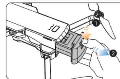
Drücken Sie auf den Schnappverschluss und ziehen Sie die Batterie aus dem Rumpf.
