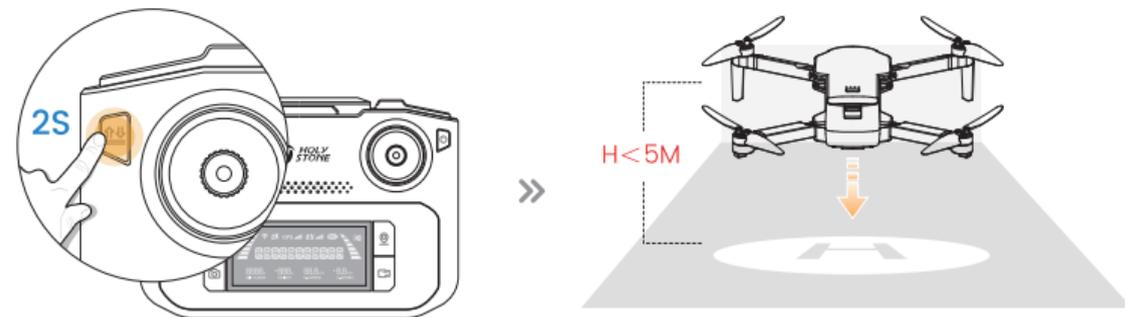
Halten Sie die Taste (
