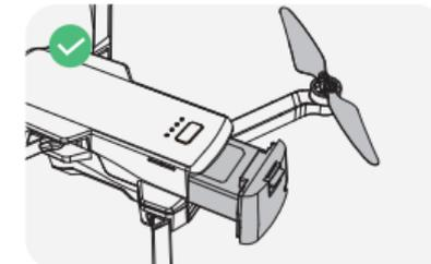
Vergewissern Sie sich, dass die Batterie der Drohne und die Propeller fest installiert sind.
