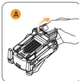
Lösen Sie die SchlieÙe am Kameradeckel.
