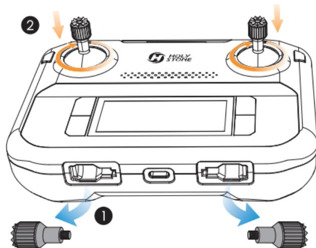
Nehmen Sie die Joysticks aus dem Staufach und montieren Sie sie auf den Transmitter.
