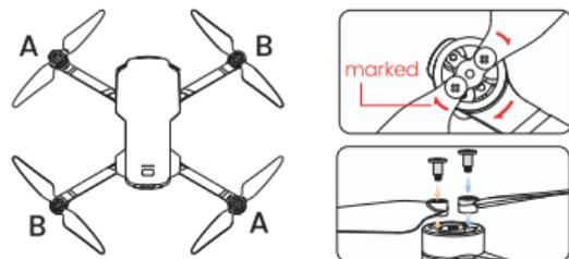
Montieren Sie die markierten Propeller auf die markierten Motorwellen. Ziehen Sie die beiden Schrauben mit dem Schraubendreher fest. Montieren Sie dann die unmarkierten Propeller auf die unmarkierten Motorwellen.
