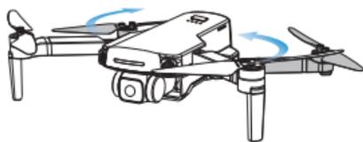
Alle Arme der Drohne sind eingeklappt, wenn sie im Werk verpackt wird. Klappen Sie zuerst die vorderen Arme und dann die hinteren Arme aus.
