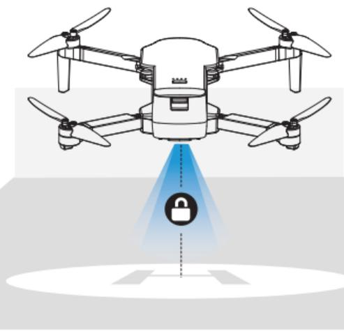
Die Drohne ist mit einer Höhenhaltefunktion ausgestattet, die es der Drohne ermöglicht, ihre Höhe zu halten, nachdem der Pilot den linken Joystick losgelassen hat. (Der linke Joystick springt automatisch in die Mitte zurück)
