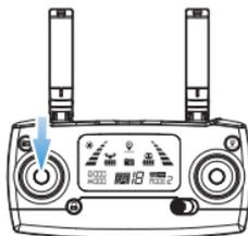
Methode 1: Nachdem die Drohne gelandet ist, ziehen Sie den Gashebel in die untere Position und halten Sie ihn 3 Sekunden lang gedrückt. Der Motor dreht sich nicht mehr und die Drohne ist verriegelt.
