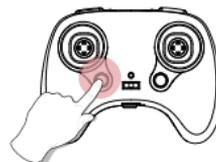
Nach der Verbindung / Kalibrierung drücken Sie die Ein-Taste-Starttaste, die Propeller beginnen sich zu drehen, um anzuzeigen, dass diese Drohne bereit zum Fliegen ist, und Sie können diese Drohne mit den Joysticks steuern. Drücken Sie erneut die One Key Landing Taste, die Drohne landet von alleine.
