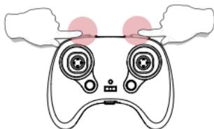
Drücken Sie gleichzeitig die obere linke und obere rechte Taste des Senders, die Motoren stoppen sofort.
