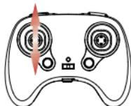
④ Drücken Sie den Gashebel nach oben und dann nach unten, um die Drohne mit dem Sender zu koppeln. Die LED-Anzeige an der Drohne leuchtet, wenn die Drohne gekoppelt ist.
