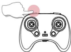
Diese Drohne kommt mit 3 Geschwindigkeitsmodi (niedrig / mittel / hoch). Drücken Sie die Speed Switch-Taste oben links am Sender, um die Geschwindigkeit zu wechseln. Erhöhen oder verringern Sie jeweils eine Geschwindigkeit. "Di" zeigt niedrige Geschwindigkeit an; "DiDi" zeigt mittlere Geschwindigkeit an und "DiDiDi" zeigt hohe Geschwindigkeit an.
