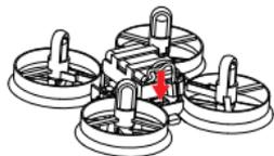
① Verbinden Sie den Batterieanschluss mit dem Rumpf-Stromanschluss.
