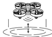
Die Drohne ist mit einer Höhenhaltefunktion ausgestattet, so dass die Drohne ihre Höhe beibehalten kann, nachdem Sie den linken Stick losgelassen haben (der linke Stick springt automatisch in die Mitte zurück).
