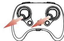
Wie in der Abbildung oben gezeigt, drücken Sie den linken und rechten Joystick gleichzeitig in die untere linke Ecke, um den Kreislauf zu kalibrieren. Die LED-Leuchten der Drohne werden schnell blinken und leuchten. Wenn Sie 2 Signaltöne vom Sender hören, die anzeigen, dass die Kalibrierung abgeschlossen ist.
